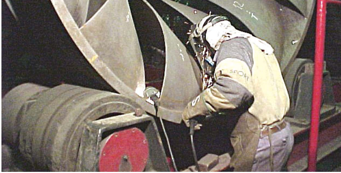
EL RODETE, MIENTRAS SE LE REALIZA EL MANTENIMIENTO EN MENDOZA
